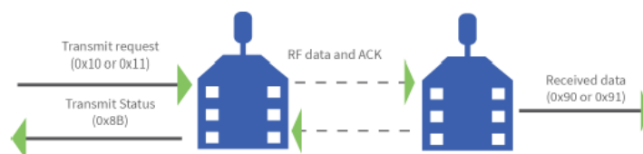
Gambar 2.14 Mengirim dan Menerima Data XBee
