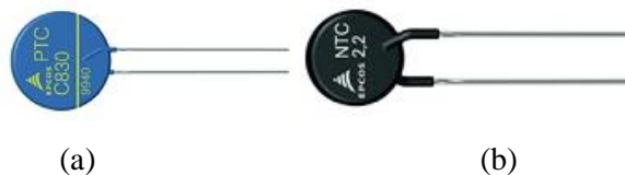
Gambar 2.6 Jenis-jenis Thermistor NTC (a) dan PTC (b)
