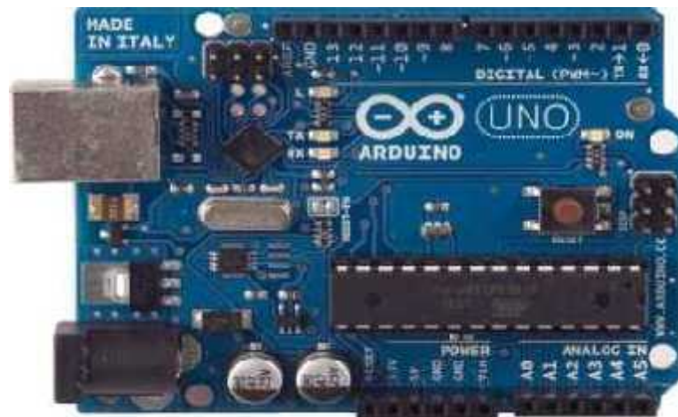
Gambar 2.9. Bentuk fisik Arduino Uno
