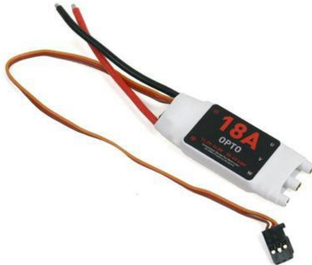
**Gambar 2.20** Contoh Bentuk Fisik ESC.
