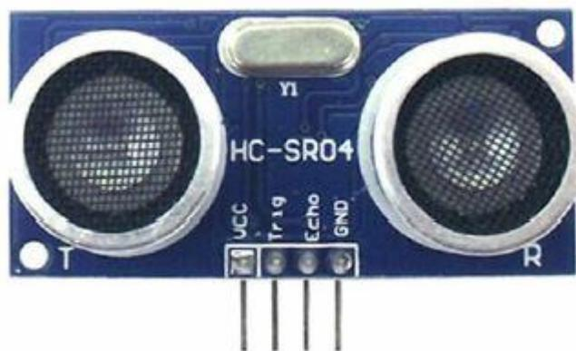
**Gambar 2.13** Koneksi pada sensor ultrasonik HC-SR04
