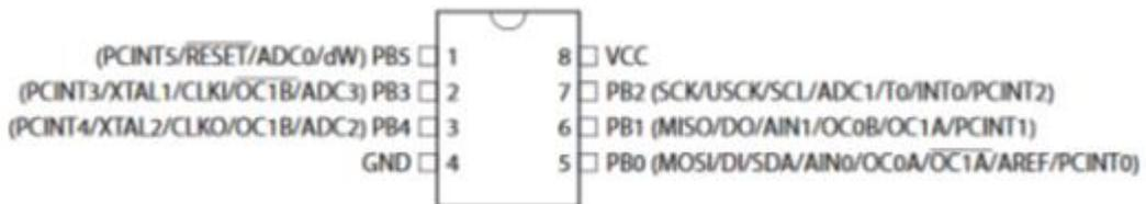
Gambar 2.9 Konfigurasi Pin ATtiny85
