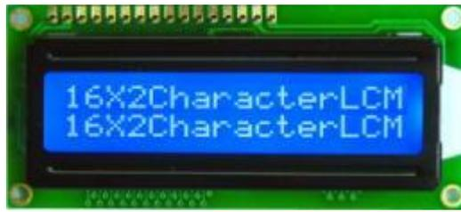
Gambar 2.19 LCD 16x2
