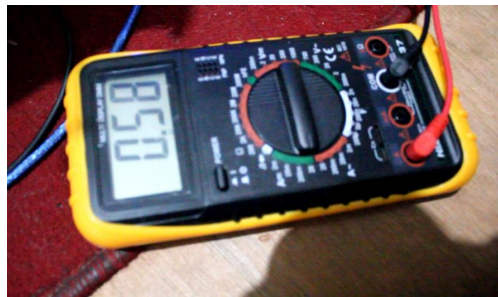
Gambar Proses Pengukuran Arus Motor Servo
