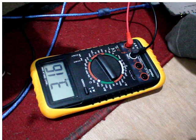
Gambar Proses Pengukuran Tegangan Motor Servo
