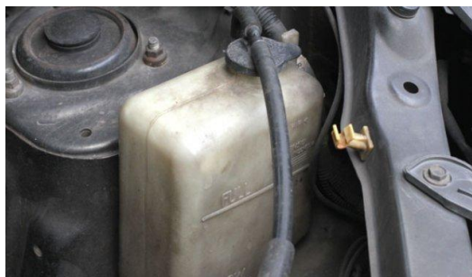
Gambar 2.3 Reservoir tank atau tangki cadangan [3]
