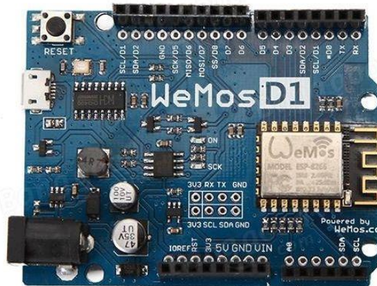
Gambar 2.9 Wifi Module ESP8266 [5]
