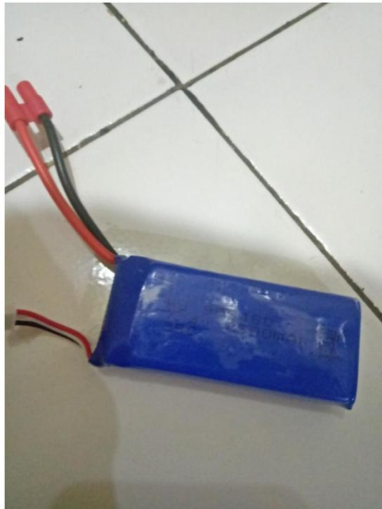
**Gambar 2.5** Baterai LiPo (*Lithium Polimer*) 2500mAh
