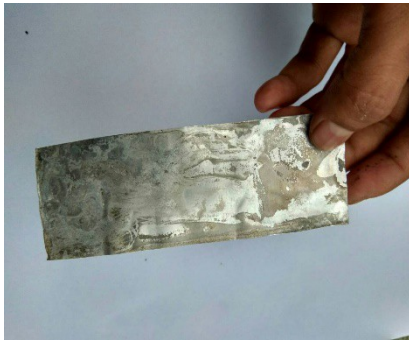
Gambar 34. Aluminium Sebelum Korosi
