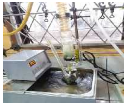
Campuran alga kering + n-Heksan 250 mL pada Alat Sokhlet
