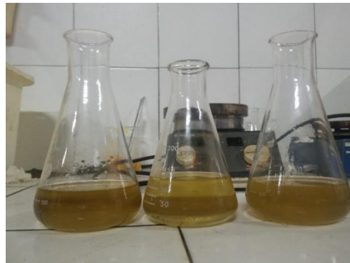
Gambar 6. Minyak dari Pelarut Kerosin (300 gr, 600 gr, 900 gr)
