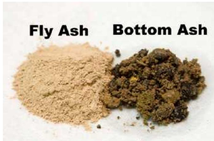
Gambar 1. Perbandingan Sifat Fisik *Fly Ash* dan *Bottom Ash*
