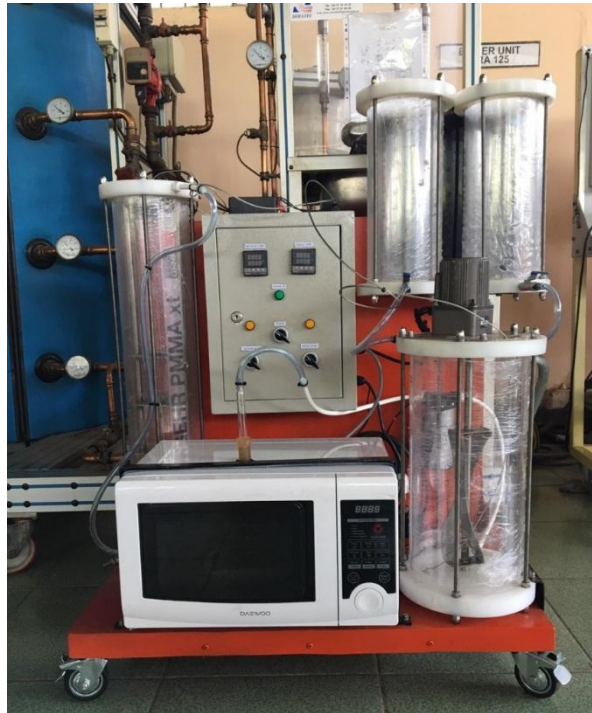
Gambar 21. Prototype Pembuatan Biodiesel dengan Pemanfaatan Gelombang Mikro dan Tegangan Tinggi
