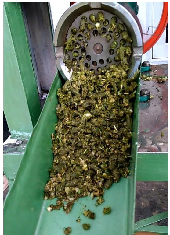
Hasil penggilingan sampah yang keluar dari lubang gilingan
