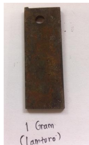
Gambar 41. Plat besi dengan penambahan inhibitor 1 gram
