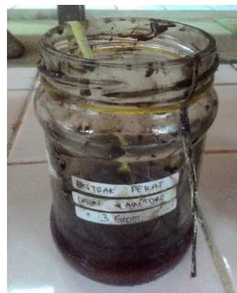
Gambar 37. Perendaman plat besi pada medium NaCl 3% dengan inhibitor 3 gram
