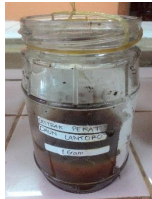
Gambar 35. Perendaman plat besi pada medium NaCl 3% dengan inhibitor 1 gram
