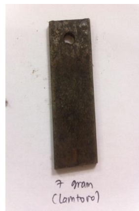
Gambar 45. Plat besi dengan penambahan inhibitor 7 gram
