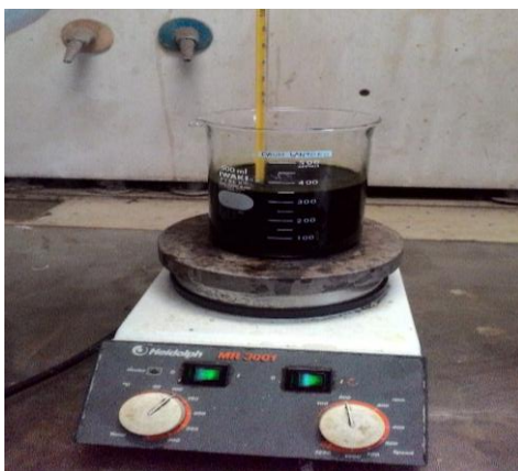
Gambar 30. Tahap pemanasan residu di hot plate.
