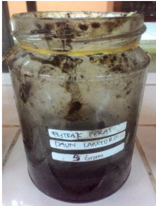
Gambar 38. Perendaman plat besi pada medium NaCl 3% dengan inhibitor 5 gram
