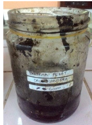
Gambar 39. Perendaman plat besi pada medium NaCl 3% dengan inhibitor 7 gram
