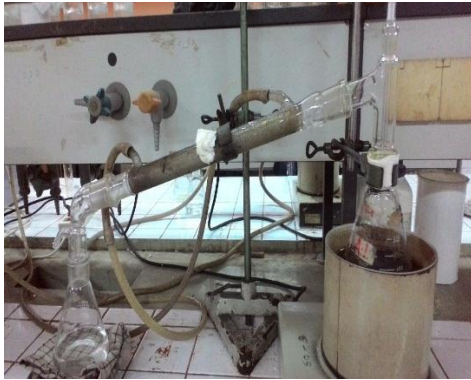
Gambar 28. Tahap destilasi selama 12 jam
