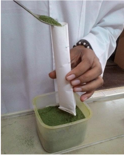
Gambar 25. Tahap pengisian serbuk daun lamtoro kedalam kertas saring
