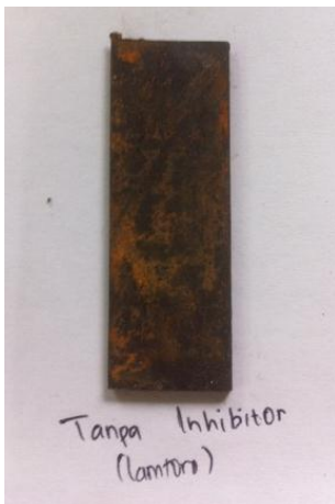
Gambar 40. Plat besi tanpa penambahan inhibitor
