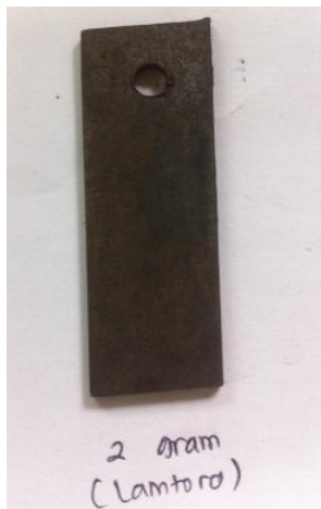
Gambar 42. Plat besi dengan penambahan inhibitor 2 gram
