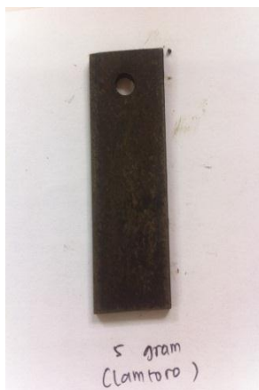
Gambar 44. Plat besi dengan penambahan inhibitor 5 gram
