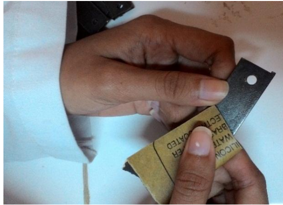
Gambar 32. Tahap pengamplasan logam besi
