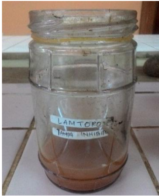
Gambar 34. Perendaman plat besi pada medium NaCl 3% tanpa inhibitor
