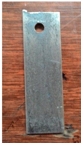
Gambar 33. Permukaan awal logam besi setelah diampelas
