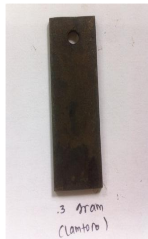
Gambar 43. Plat besi dengan penambahan inhibitor 3 gram
