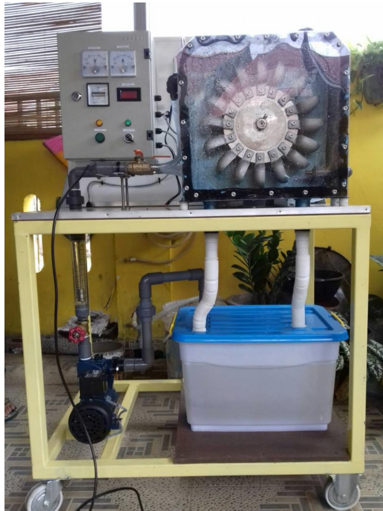
Gambar 13. Alat Simulasi PLTMH Turbin Pelton
