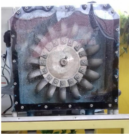
Gambar 14. Komponen Pada Simulasi PLTMH Turbin Pelton (a) Tangki Penampung, (b) Pompa Sentrifugal, (c) Generator, (d) Turbin Pelton, (e) Inverter 300 Watt, (f) Flowmeter
