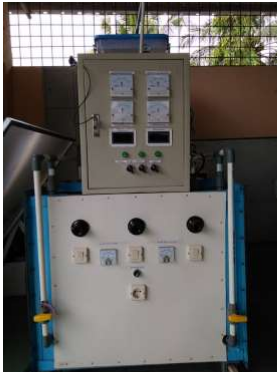
Gambar 37. Panel Pengukur RPM, Arus, dan Tegangan Listrik Digital
