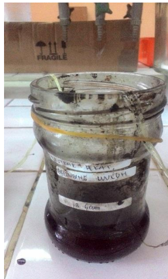
Gambar 32. Perendaman Plat Besi Pada Medium NaCl 3% Dengan Inhibitor 3 gram
