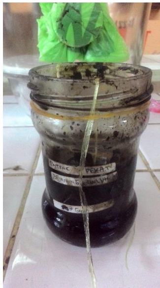
Gambar 34. Perendaman Plat Besi Pada Medium NaCl 3% Dengan Inhibitor 7 gram
