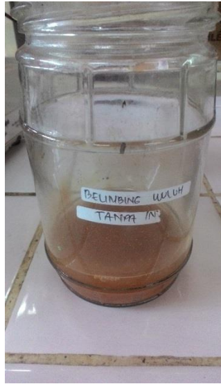
Gambar 29. Perendaman Plat Besi Pada Medium NaCl 3% Tanpa Inhibitor
