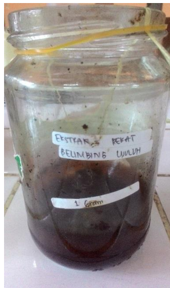
Gambar 30. Perendaman Plat Besi Pada Medium NaCl 3% Dengan Inhibitor 1 gram
