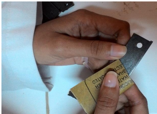
Gambar 27. Pengamplasan Logam Besi yang akan digunakan
