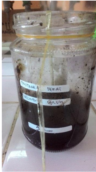
Gambar 33. Perendaman Plat Besi Pada Medium NaCl 3% Dengan Inhibitor 5 gram
