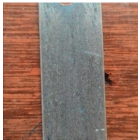
Gambar 28. Permukaan awal logam besi setelah diampla
