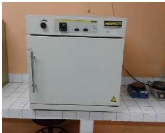
Gambar 58. Proses Pengovenan (Uji Kadar Air) Pada Suhu 105°C Selama 1 Jam
