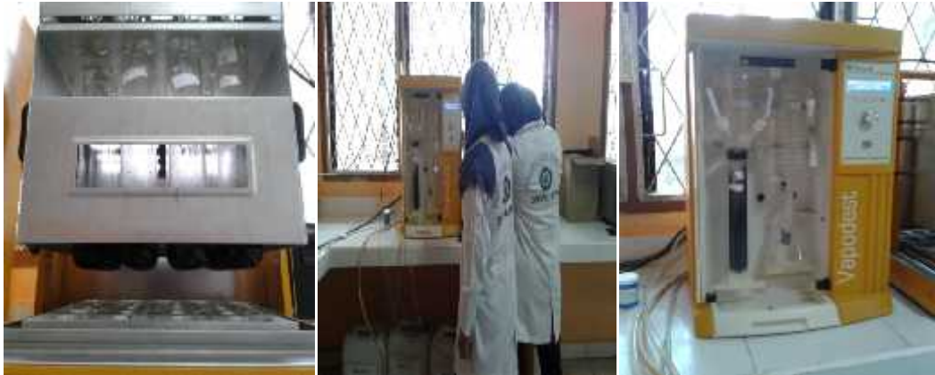
Gambar 50. Campuran gelatin dan protein ditambah reagen+ \text{H}_2\text{SO}_4 12 mL (destruksi) dilanjutkan dengan destilasi hasil destruksi
