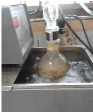
Gambar 31. Tulang di ekstraksi selama 5 jam pada suhu 90°C
