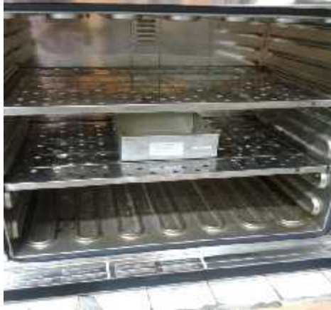
Gambar 45. Pengeringan gumpalan susu pada suhu 50°C selama 3 jam
