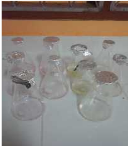
Gambar 51. Hasil destilasi yang telah ditambah Larutan \text{NaOH} 0,1N, Larutan \text{H}_3\text{BO}_3 , Dan Indikator Metylen Red. Campuran dengan Larutan \text{NaCl} berwarna kuning, sedangkan campuran dengan Larutan \text{CH}_3\text{COOH} berwarna merah muda
