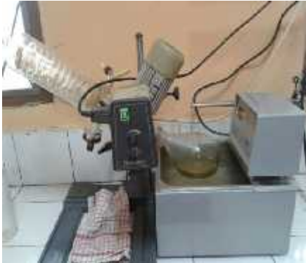
Gambar 34. Ekstrak gelatin di evaporasi selama 5 jam pada suhu 70°C
