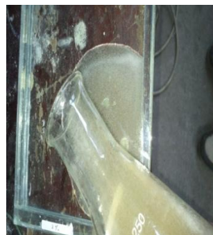
Gambar 9. Proses Penuangan Dope
