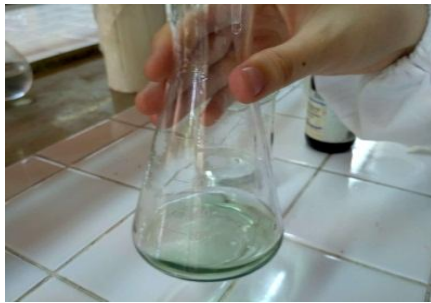
Gambar 17. Proses Titrasi COD
