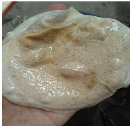
Gambar 15. Membran yang sudah dilewatkan limbah cair kelapa sawit
