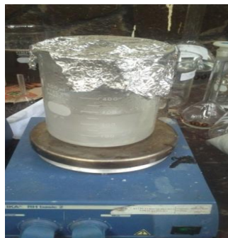
Gambar 6. Pembuatan Larutan PVA
