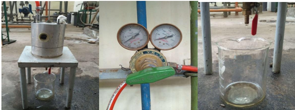
Gambar 14. Penentuan Uji Fluks Membran
