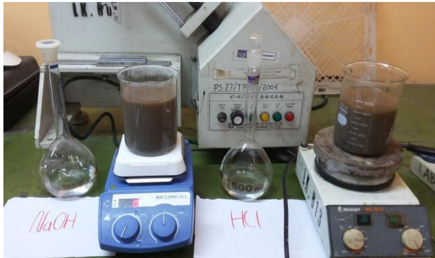
Proses Pemanasan Campuran Silika dan Pengekstrak
