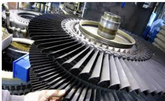
Gambar 4 Bentuk sudu-sudu turbin uap
