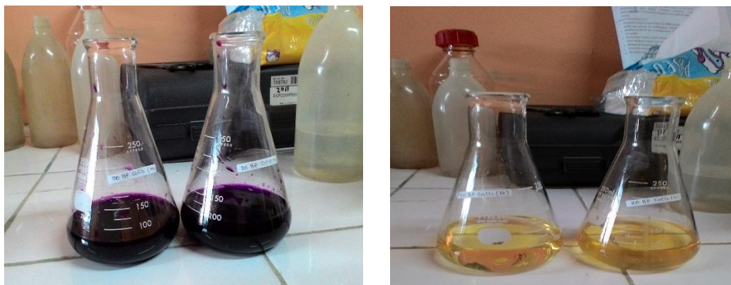
Gambar 18. Aplikasi Campuran Karbon Aktif terhadap Logam Berat Mangan (Mn) dan Besi (Fe)
