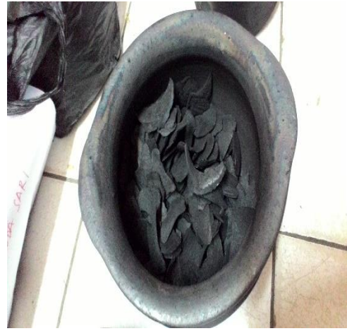
Gambar 10. Proses Karbonisasi Tempurung Kelapa
