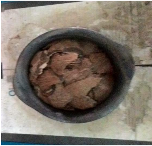
Gambar 10. Proses Karbonisasi Tempurung Kelapa
