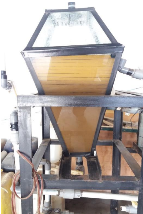
Gambar 13 Mengamati Proses Sedimentasi Selama 24 jam
