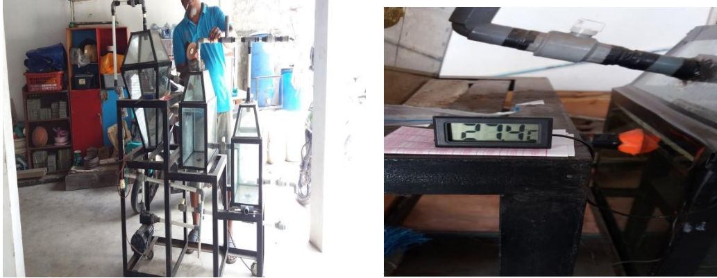
Gambar 9 dan 10 Proses Pembuatan Alat Modifikasi Digester dengan Penambahan Sensor Temperatur dan Agitator
