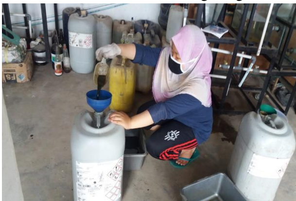
Gambar 7 Proses pembuatan substrat dari campuran POME dan kotoran Sapi
