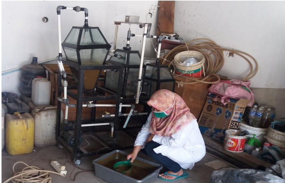
Gambar 12 Persiapan Umpan POME Untuk Tangki Sedimentasi
