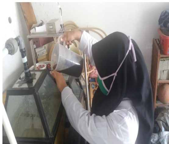
Gambar 14 Penambahan konsentrasi Substrat 30% pada Tangki 2
