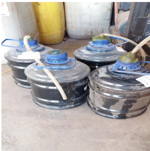
Gambar 14 Pengambilan Sampel limbah setelah fermentasi untuk dianalisa kandungan COD dan BOD
