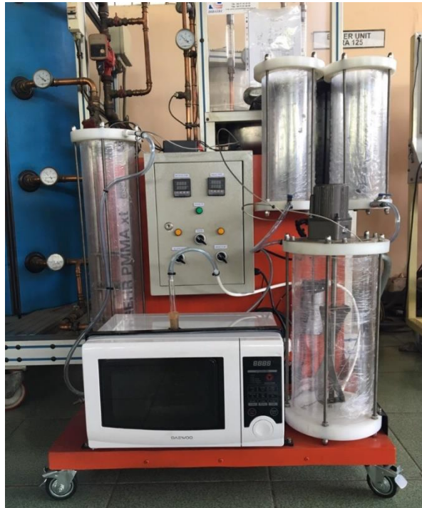
Gambar 1. Prototype Pembuatan Biodiesel dengan Pemanfaatan Gelombang Mikro dan Tegangan Tinggi
