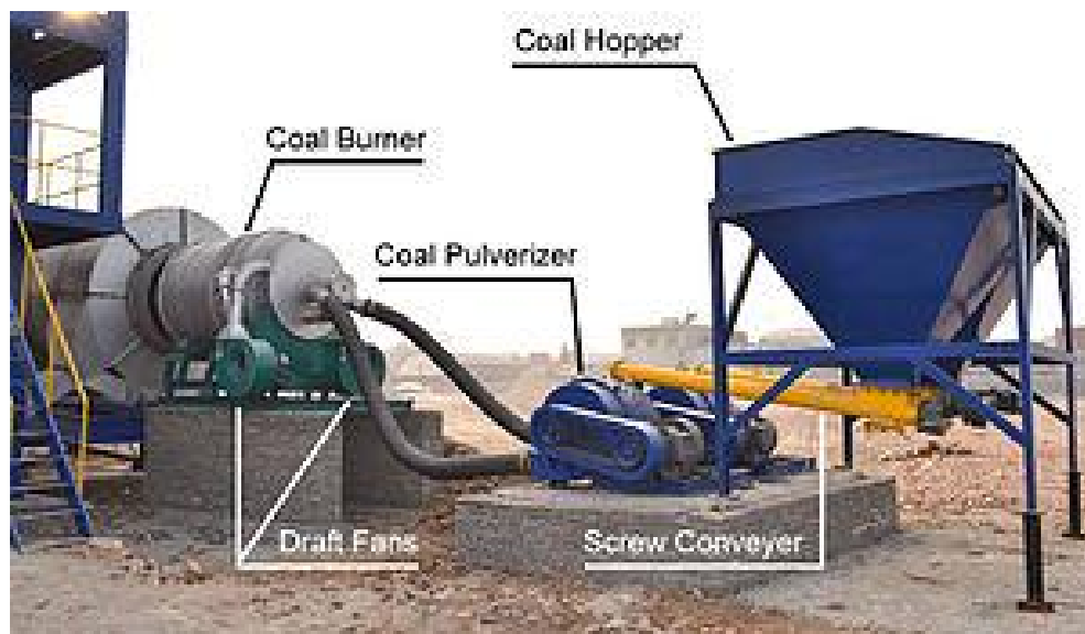
Gambar 3. Struktur utama coal burner
