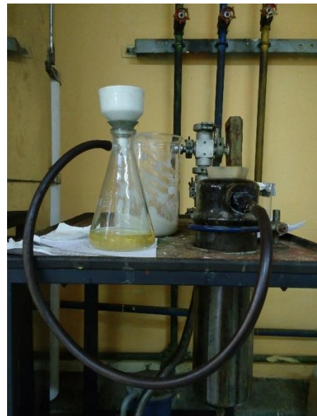
Gambar 7. Hasil Presipitasi Disaring Menggunakan Pompa Vakum
