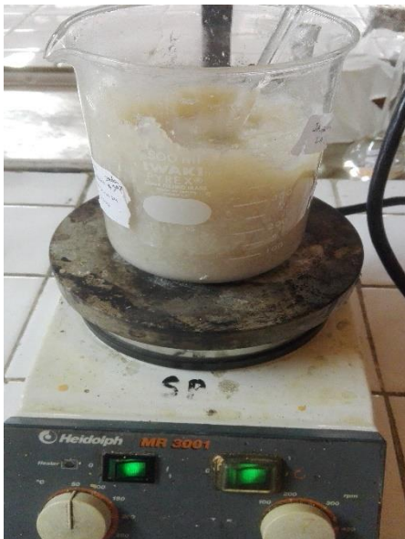
Gambar 6. Presipitasi Ekstrak Silika Menggunakan \text{H}_2\text{SO}_4 2 M
