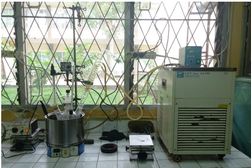
Gambar 3. Ekstraksi Abu Sekam Padi Menggunakan Pelarut KOH 2 M
