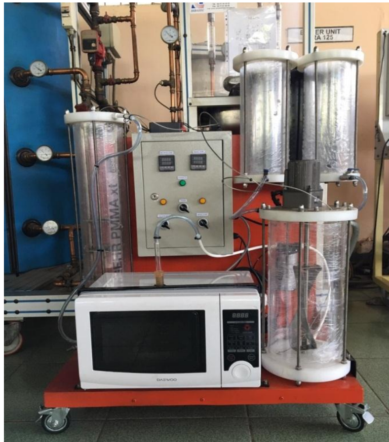
Gambar 20. Prototype Pembuatan Biodiesel dengan Menggunakan Radiasi Gelombang Mikro dan Tegangan Tinggi
