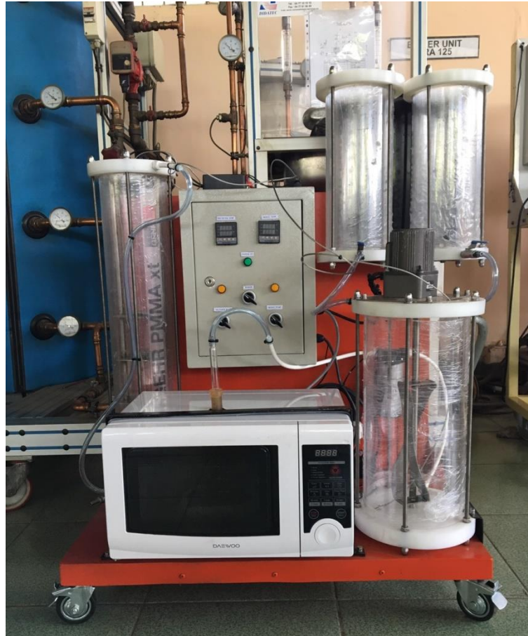
Gambar 18. Prototype Biodiesel Reaktor Gelombang Mikro
