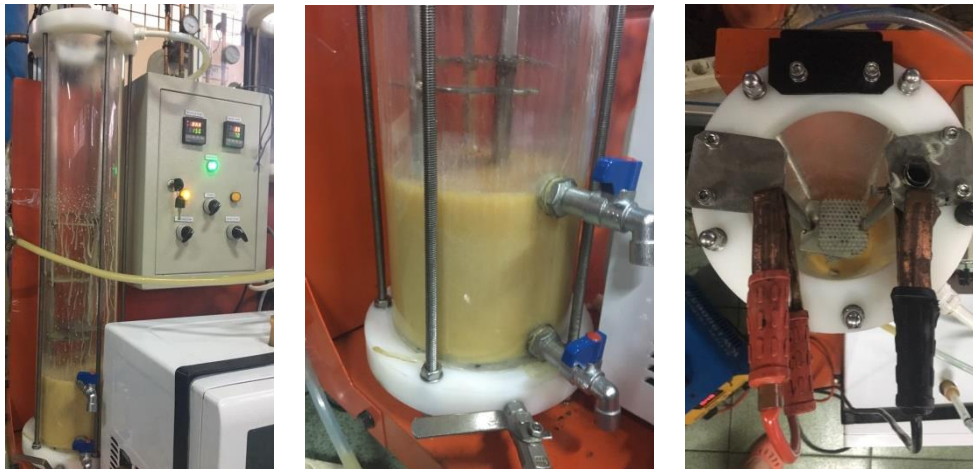
Gambar 23. Separator Prototype Biodiesel Tegangan Tinggi
