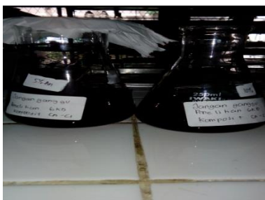
Gambar 3.20 Pengendapan Komposit selama 24 jam
