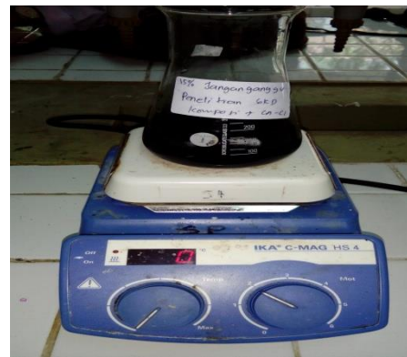
Gambar 3.19 Proses pencampuran larutan 1% kitosan 15ml dengan 15 gr karbon aktif
