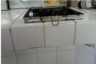
Gambar 3.12 Proses pengeringan karbon aktif yang telah netral pH nya
