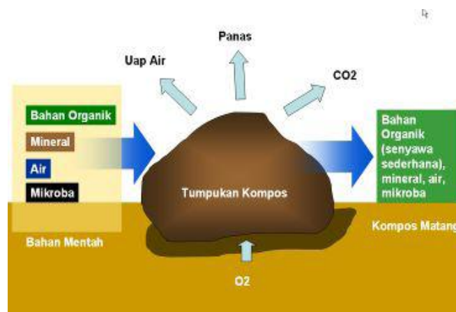
Gambar 3. Proses Umum Pengomposan Limbah Padat Organik (dimodifikasi dari Rynk,1992)
