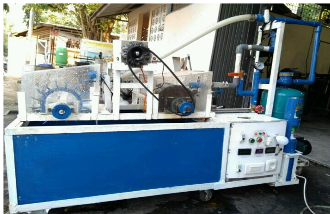
Gambar 21. Prototipe Pembangkit Listrik Tenaga Mikrohidro
