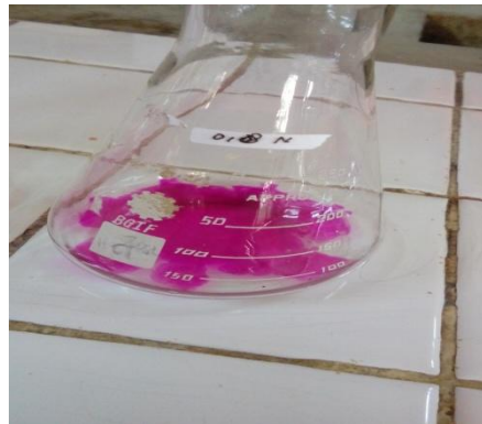
Gambar 28. Sampel ditambah indikator pp
