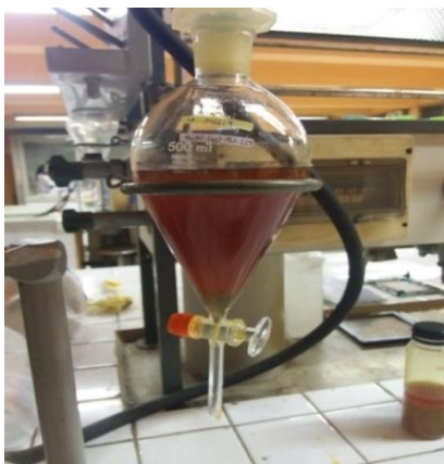
Gambar 5. Hasil Esterifikasi dicuci
