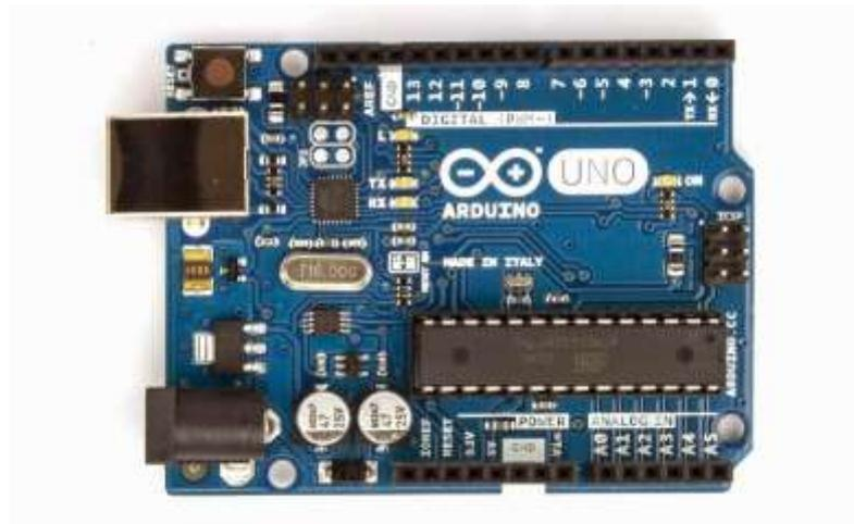
**Gambar 2.8** Mikrokontroler Arduino UNO
