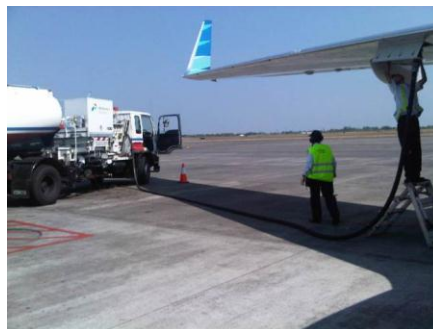
Gambar 2.17 Pengisian Bahan Bakar dengan Truk Tangki (Sumber : https://veeone120184.wordpress.com )
