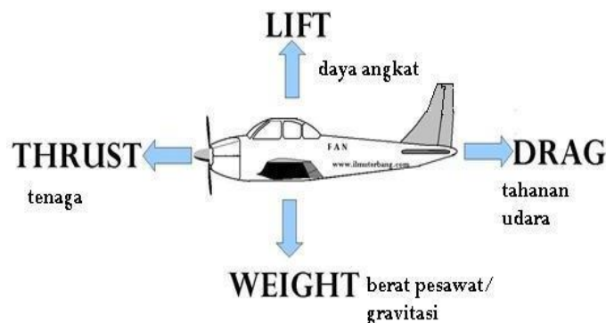
Gambar 2.3 Gaya yang Bekerja pada Pesawat Udara (Sumber: Lit. 15)
