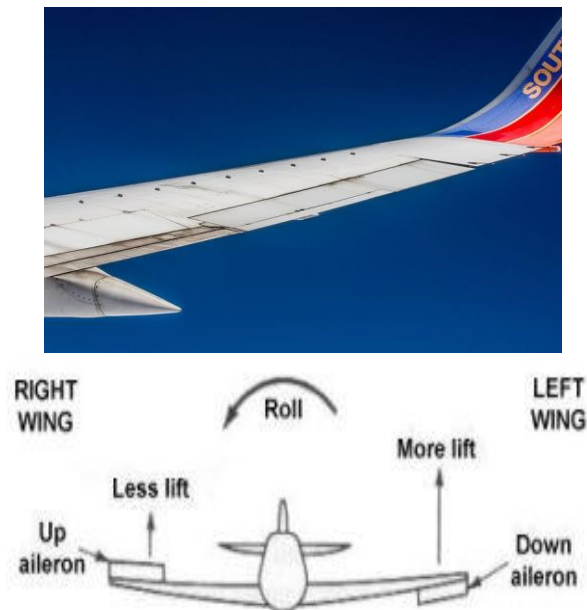
Gambar 2.17 (a) Aileron (b) Gerakan aileron Sumber : http://aeroengineering.co.id
