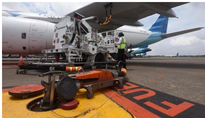
Gambar 2.18 Pengisian Bahan Bakar dengan Fuel Hydrant (Sumber : https://bisnis.tempo.co )
