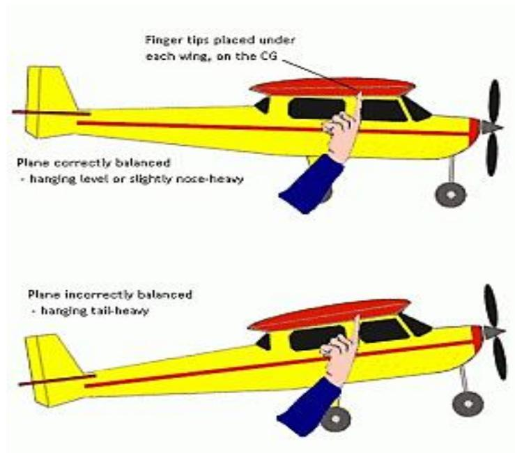
Gambar 2.23 Cara Menentukan CG pada Aeromodeling
