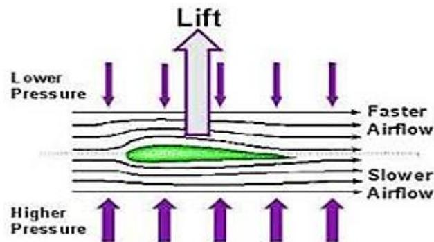
Gambar 2.21 Arah Aliran Fluida Pada *Airfoil*
