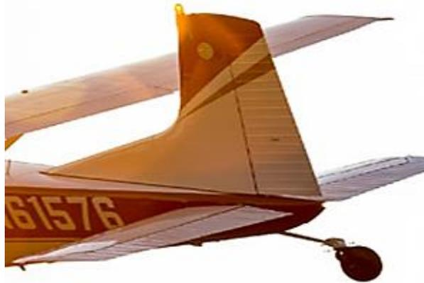
Gambar 2.7 *Empennage* Pesawat Cessna 180 Skywagon
