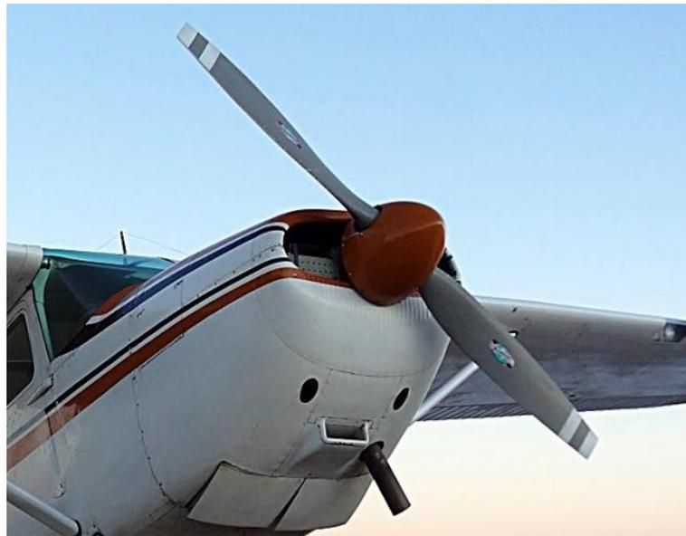
Gambar 2.31 *Propeller* Pesawat Cessna 180 Skywagon
