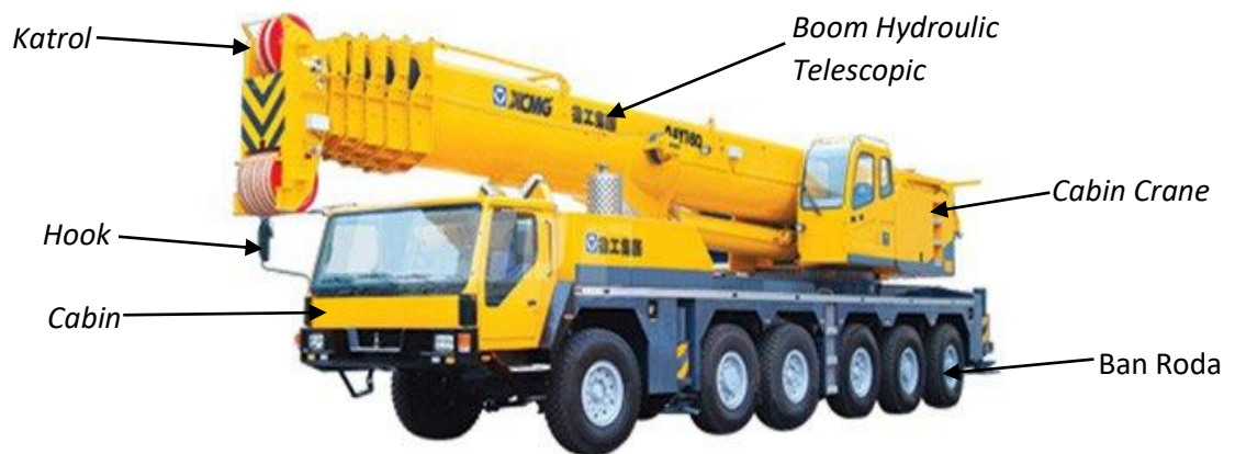
Gambar 2.2 Mobile Crane / Truck Crane Beserta Bagian – Bagiaannya
