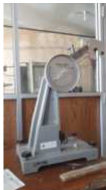
Gambar 2.13 Mesin Uji Impact
