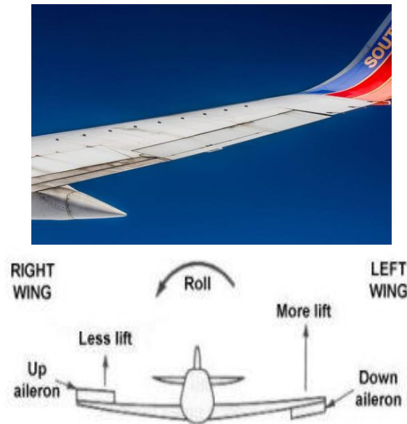
Gambar 2.17 (a) Aileron (b) Gerakan aileron Sumber : http://aeroengineering.co.id
