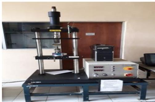
Gambar 2.10 Mesin Uji *Bending*
