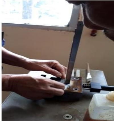
Gambar 2.9 Proses Pembuatan *Notch* (Takik)
