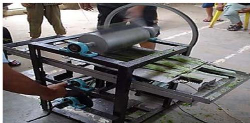
Gambar 2.1 Alat Pengesut Daun Nenas Berpenggerak Motor Listrik
