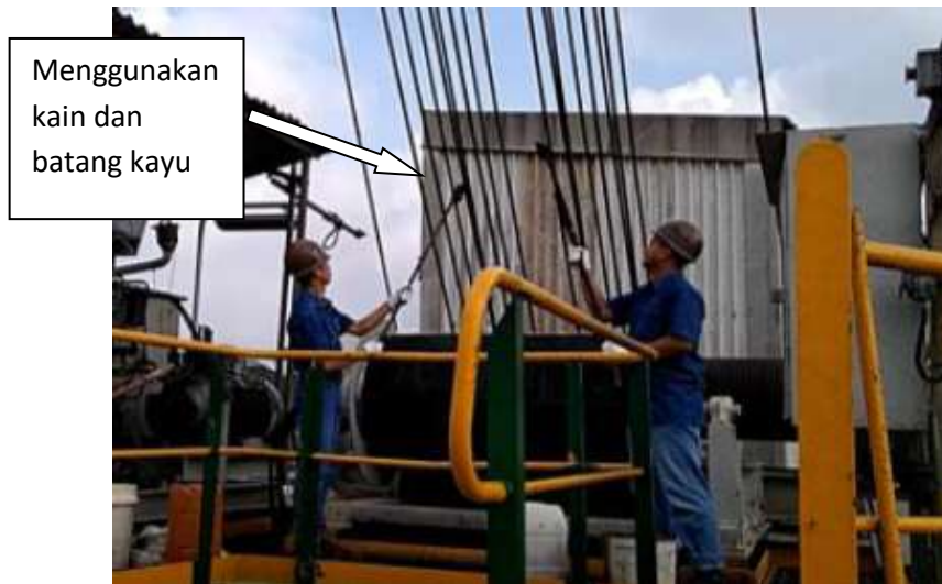
Gambar 2.5 Kegiatan Pelumasan sebelum ada alat turbo 01
