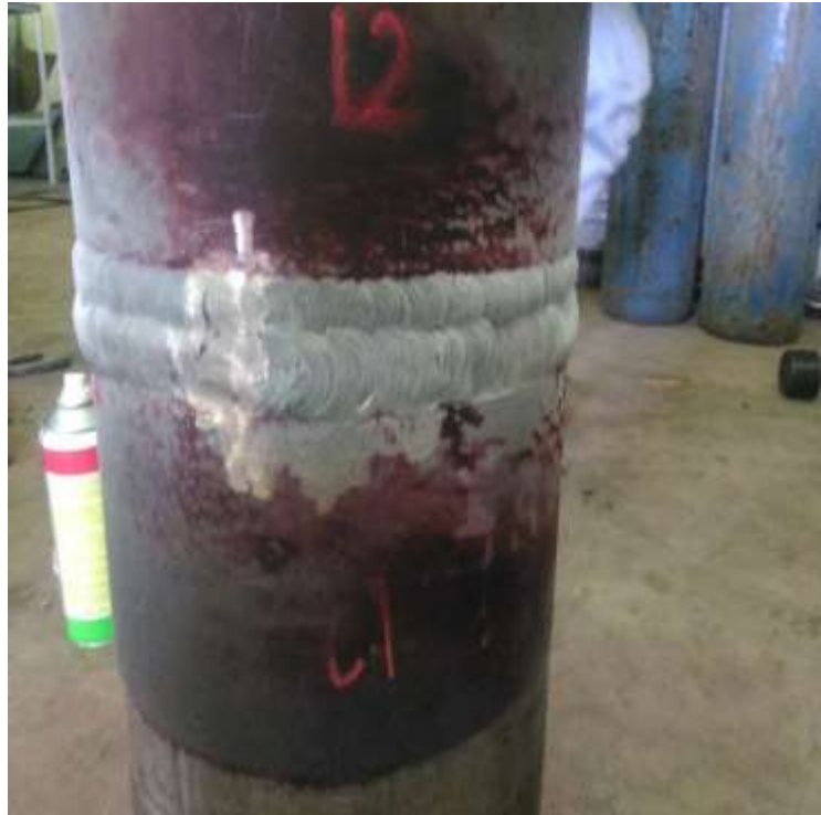
Gambar 5 Pipa Setelah disemprot cairan developer.
