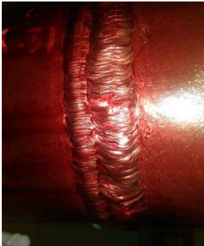
Gambar 4 Pipa hasil las SMAW
