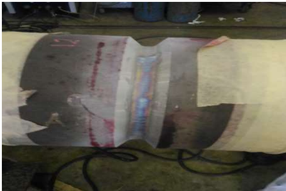
Gambar 3 Pipa setelah disemprot Developer
