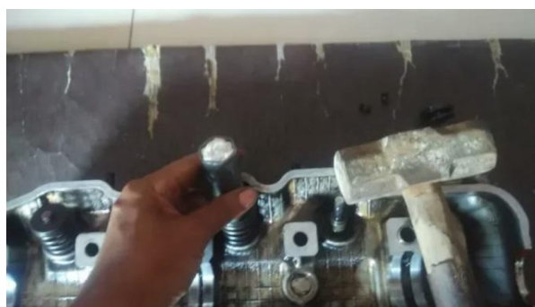
Gambar 2.12 Proses pelepasan valve secara tradisional (Sumber: http://mecanik_online/-cara-melepas-klep-katup-mesin/ )
