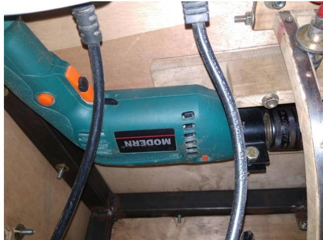
Gambar 2.13 Mesin Bor Tangan pada Circular Saw
