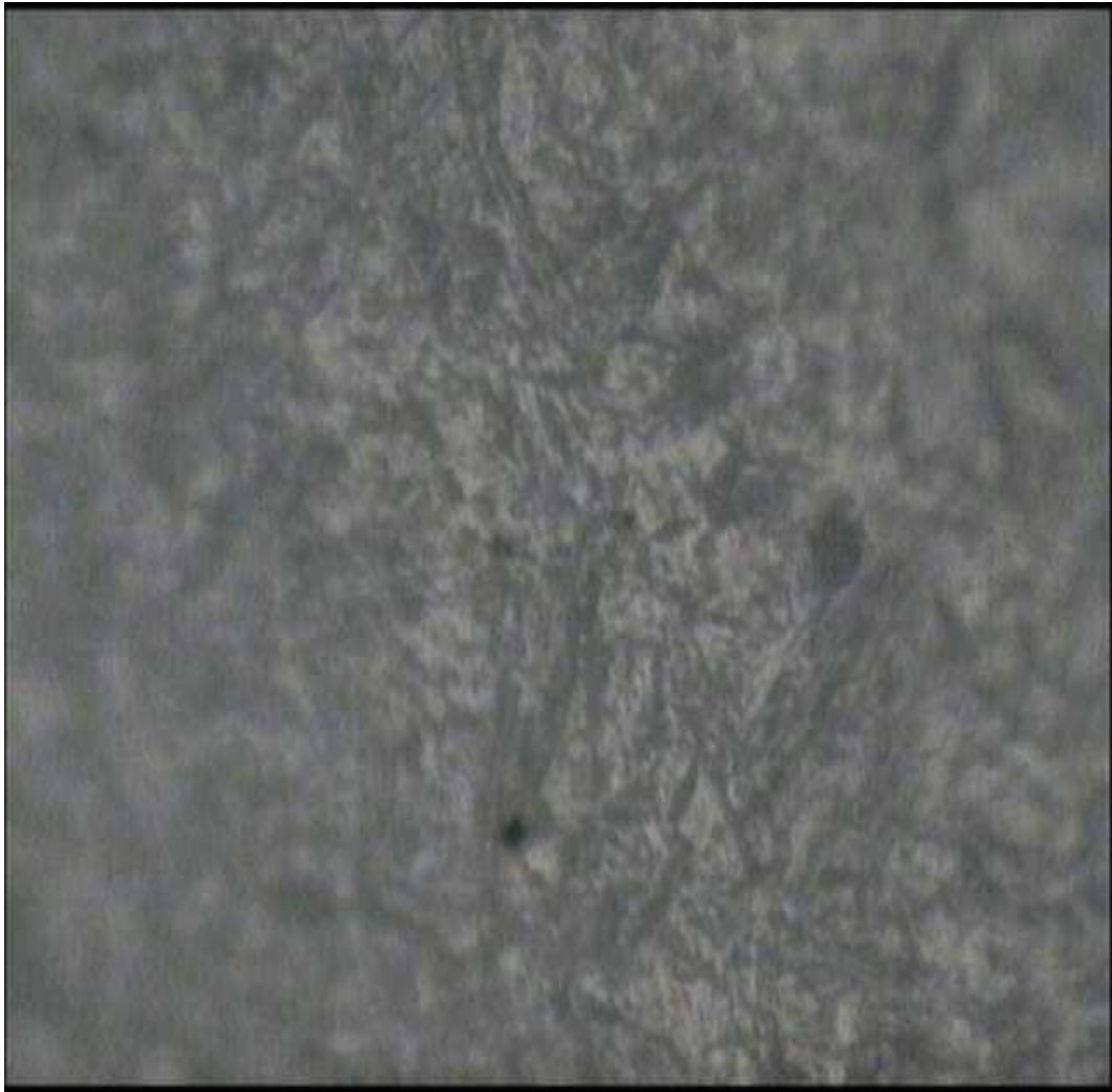
GambarFotoStrukturMikroSetelahMelalui Proses Pack Carburizing Paling Optimal
