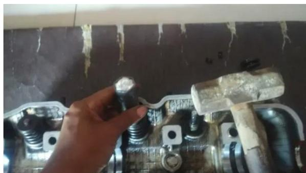
Gambar 2.12 Proses pelepasan *valve* secara tradisional
